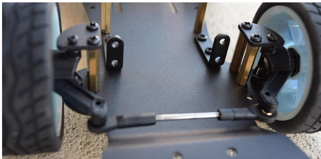
Mise en place de la barre de direction à écartement réglable
