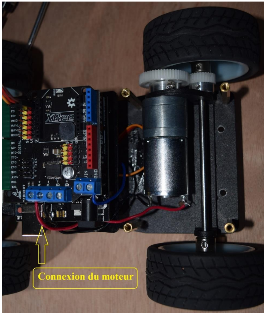
Installation des 2 cartes superposées et connexion du moteur arrière
