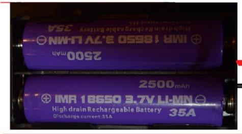
Utilisation de 2 batteries rechargeables LI-Ion de 3,7 Volts soit une tension totale de 7,4 Volts à relier à "VIN".
