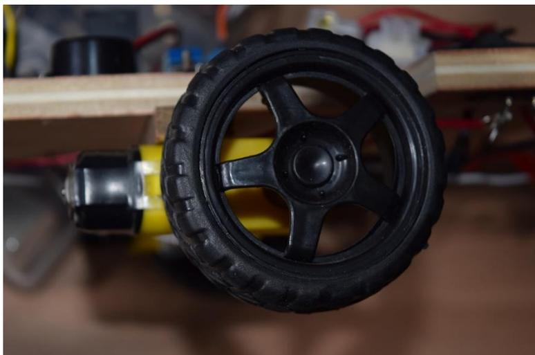
*Les deux roues arrières n'ont subi aucune modification et sont simplement emboîtées sur les sections rectangulaires des axes sortant des moteurs arrières. Ce sont des roues Arduino facilement accessibles dans le commerce en ligne.*
