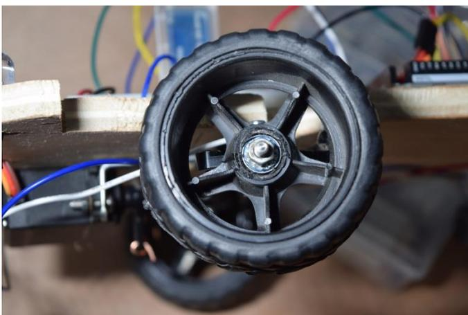
*Les roues avant sont inversées. Elles ont été percées pour pouvoir encastrer 2 petits roulements à billes et leur largeur au niveau de l'axe a été réduite pratiquement de moitié afin de pouvoir les fixer sur l'axe prévu sur la barre de direction. Une petite rondelle et un écrou permettent de les fixer solidement. La largeur doit correspondre à l'épaisseur de 2 roulements soit environ 8 mm.*
