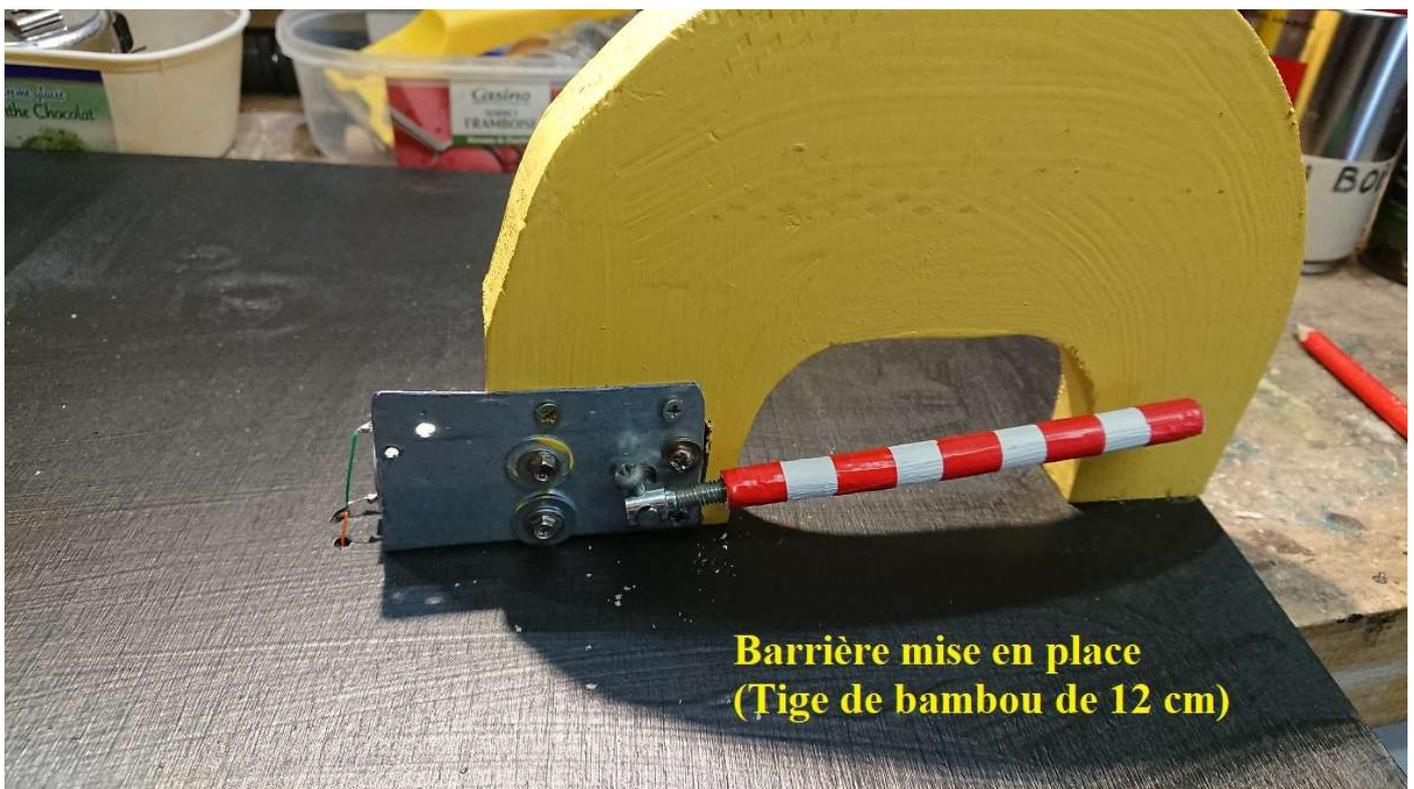
*Le moteur a été vissé derrière l'équerre métallique par 4 petites vis adaptées aux filetages pré-existants sur la partie réducteur de l'ensemble de motorisation. Un « serre-tringle » pour garde-boue vélo est fixé sur l'axe de sortie du moteur sur lequel il s'adapte à la perfection. La « barrière » constituée par une tige de bambou de 12 cm de longueur est vissée sur le filetage du serre-tringle.*
