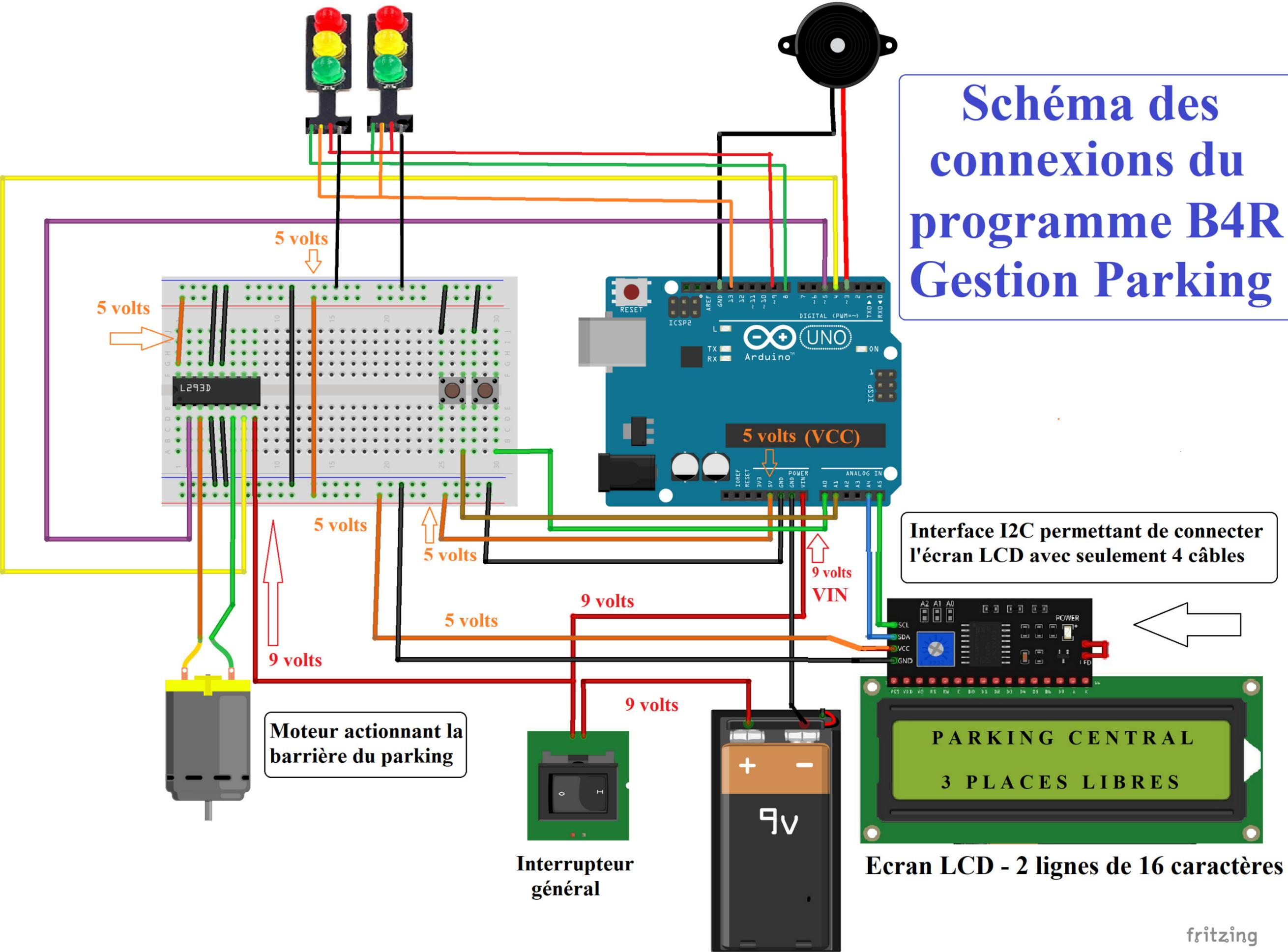
Interface I2C permettant de connecter l'écran LCD avec seulement 4 câbles
